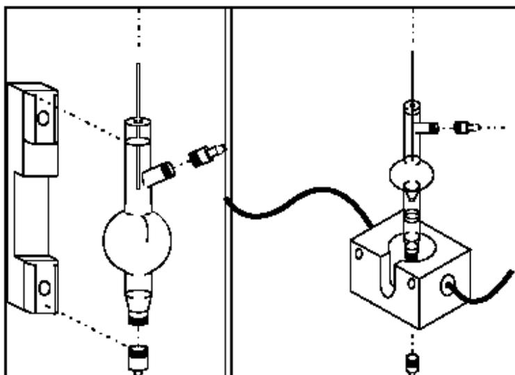
图 10 逐出液容器和测量器
