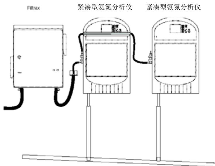
图 3 2 个紧凑型分析仪和一个 Filtrax 系统
